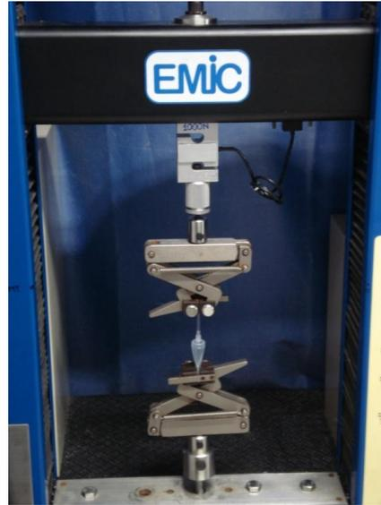
Figura 6: Ensaio de tração
