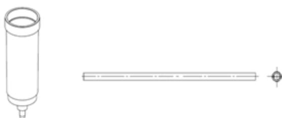
Figura 3: Câmara em PP e tubo em PVC flexível
