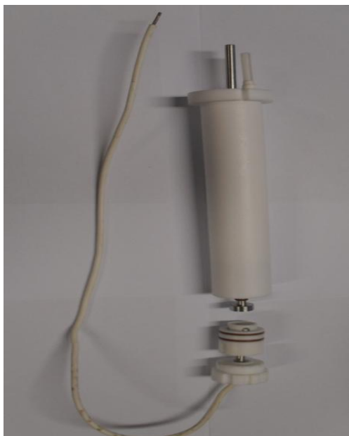
Figura 15 - Célula utilizada na realização da análise de espectroscopia de impedância eletroquímica.
