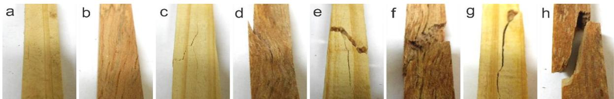
Figura 4.3 – Fraturas típicas observadas nos compósitos e controles (a-b = não fraturadas; c-d = controles; d-e = compósitos sem agentes de ligação; g-h = compósitos com agente de ligação, para pinus e guapuruvu, respectivamente).
