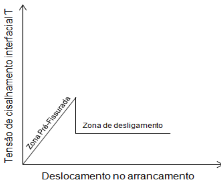
Figura 8: Representação das tensões de cisalhamento na interface fibra-matriz após desligamento parcial da fibra
