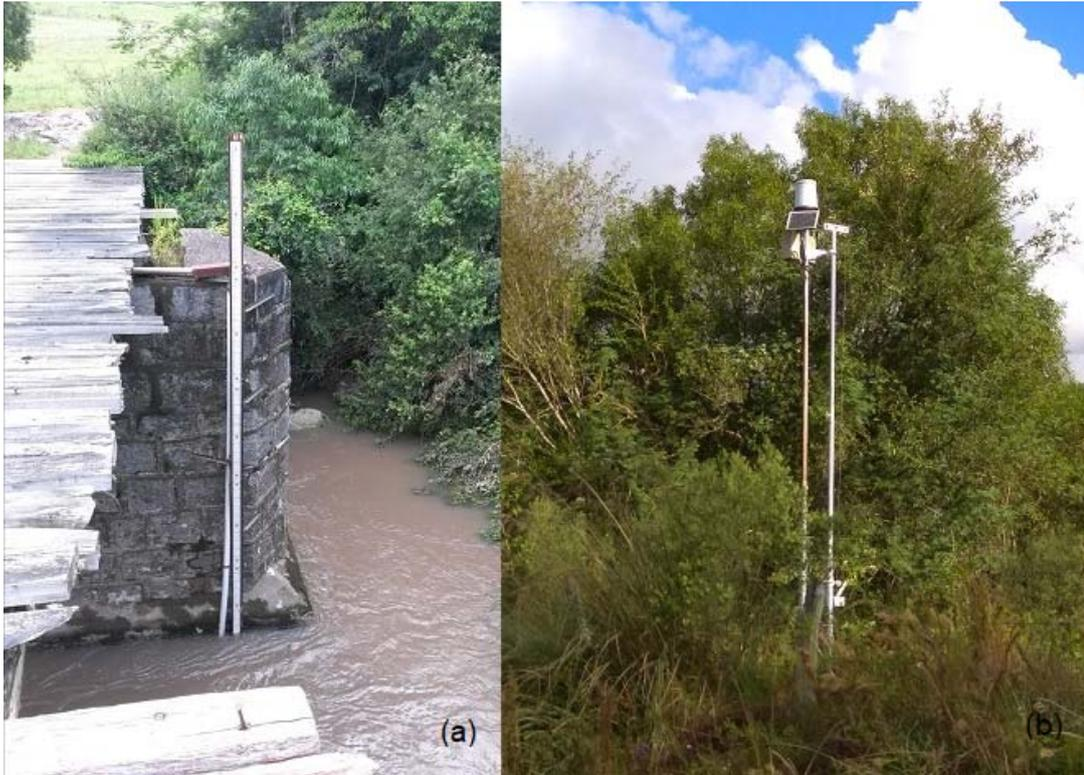
Figura 18 - Ilustração da seção de controle do arroio Cadeia com a estrutura para monitoramento automático de nível d'água e também por réguas linimétricas (a); e da unidade de aquisição e armazenamento de informações hidrológicas de chuva e de nível da estação modelo Solar SL2000PNVn, instalada na mesma seção (b)
