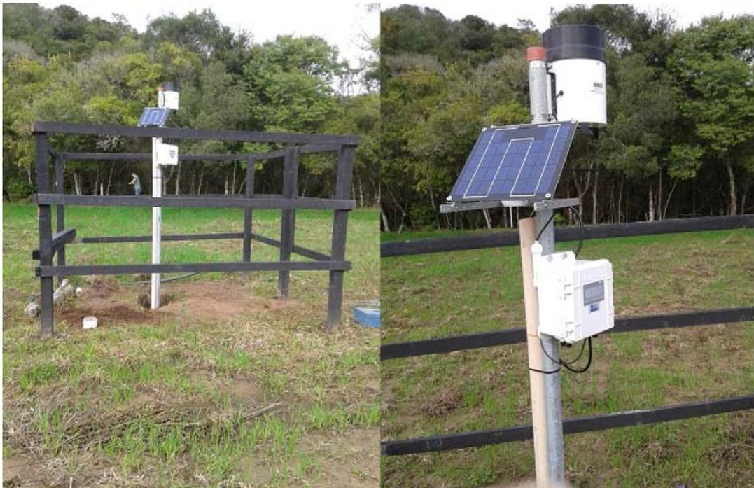
Figura 17 - Ilustração da unidade de aquisição e armazenamento de informações hidrológicas de chuva da estação EH-H03 modelo HOBO Pluviômetro Digital - U30-GSM, marca Onset
