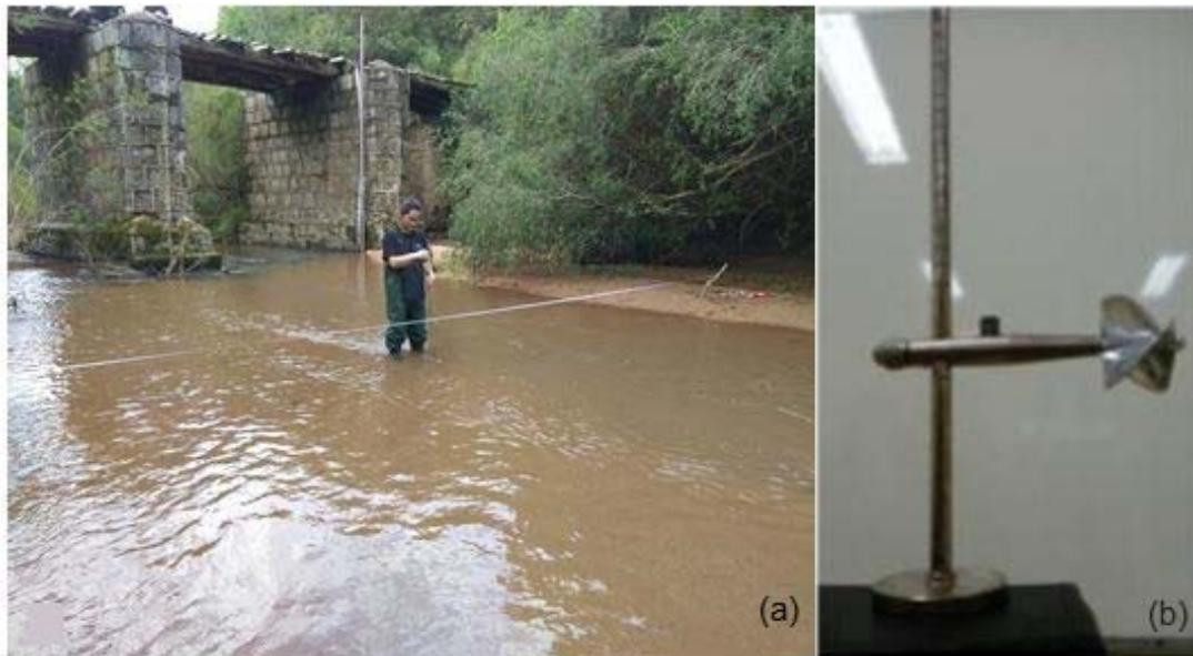
Figura 21- Campanha hidrológica para determinação de descarga líquida (a) usando micromolinete hidrométrico (b).
