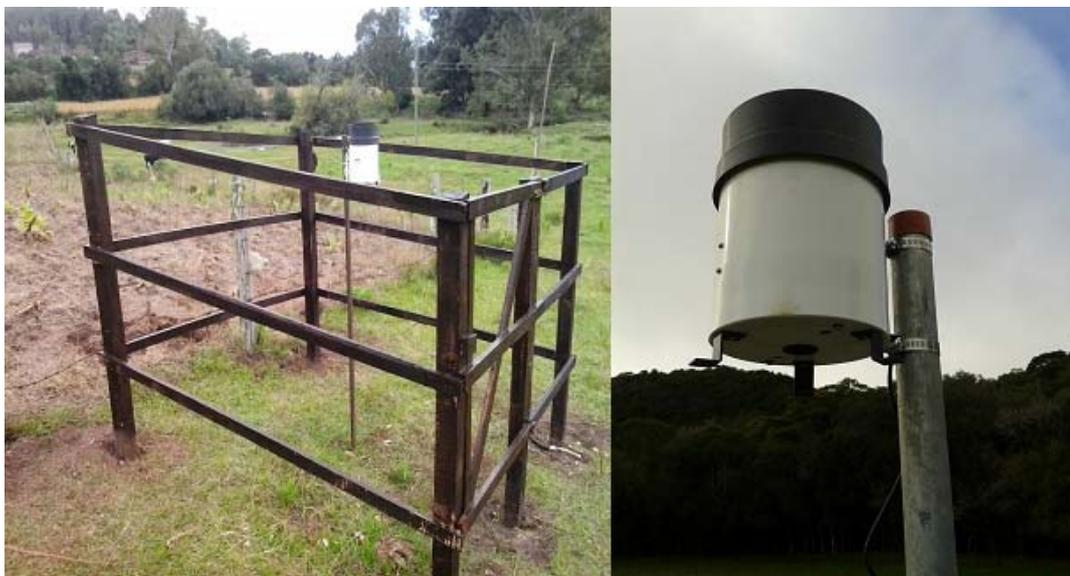
Figura 19 - Ilustração da estação pluviográfica EH-P08 modelo HOBO Pluviômetro Digital – RG3-M, marca Onset, tendo mais 9 estações deste modelo
