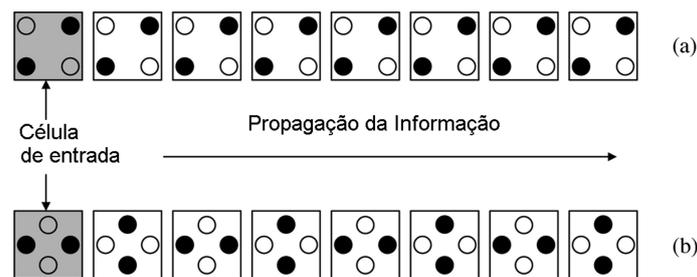
Figura 4: Fio QCA com propagação de (a)  $90^\circ$  e (b)  $45^\circ$  (KONG; SHANG; LU, 2010)
