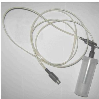
Figura 29: Sensor de temperatura encapsulado
