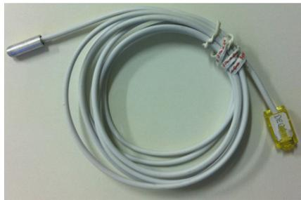
Figura 30: Sensor de temperatura
