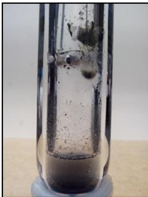
Figura 13. Aspecto da solução obtida após o procedimento de volatilização por MIC de 100 mg amostra de cimento misturadas a 400 mg grafite.
