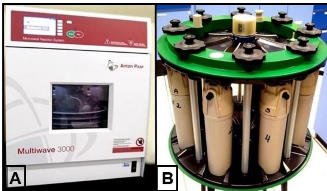
Figura 9. Equipamento utilizado para o preparo das amostras de cimento Portland: A) Forno de micro-ondas Multiwave 3000® e B) rotor equipado com oito frascos.
