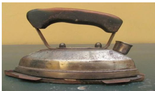
Figura 36- Fotografia do ferro elétrico usado em reentelamentos de pinturas no Ateliê da UFPel. Fonte: Autora, 2012
