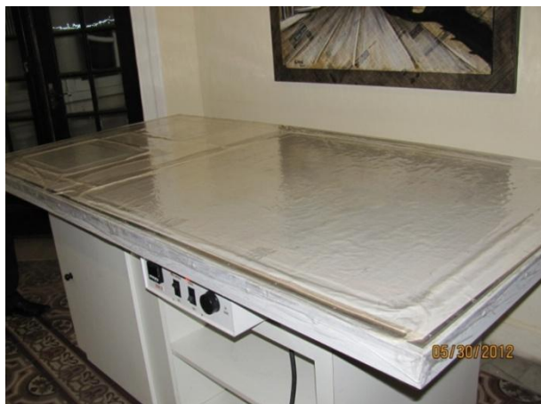
Figura 37- Fotografia da mesa térmica utilizada para reentelamento de pinturas em tela, existente no Curso de Conservação e Restauro de Bens Culturais Móveis da UFPel. Fonte: Autora, 2012.
