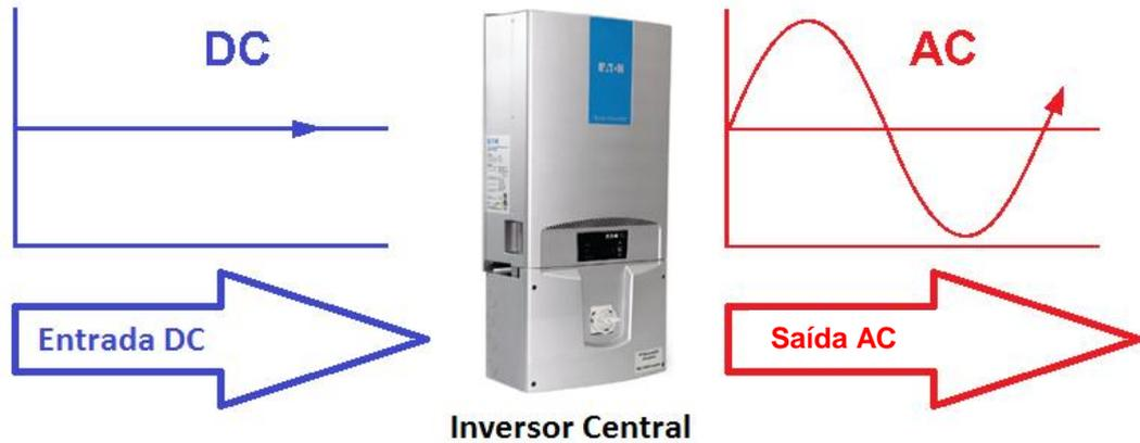
Figura 13: Corrente contínua que vem dos módulos chega ao inversor que a transforma em corrente alternada.
