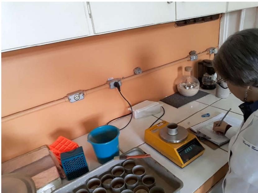
Figura 8 – Procedimento de pesagem no Laboratório de Física do Solo para avaliação do tamanho de partículas do solo.
