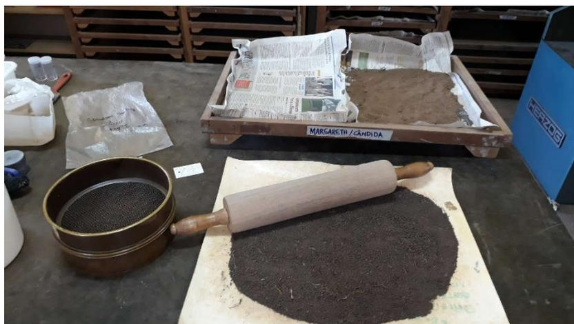
Figura 7 – Destorroamento de amostras para a preparação do solo.
