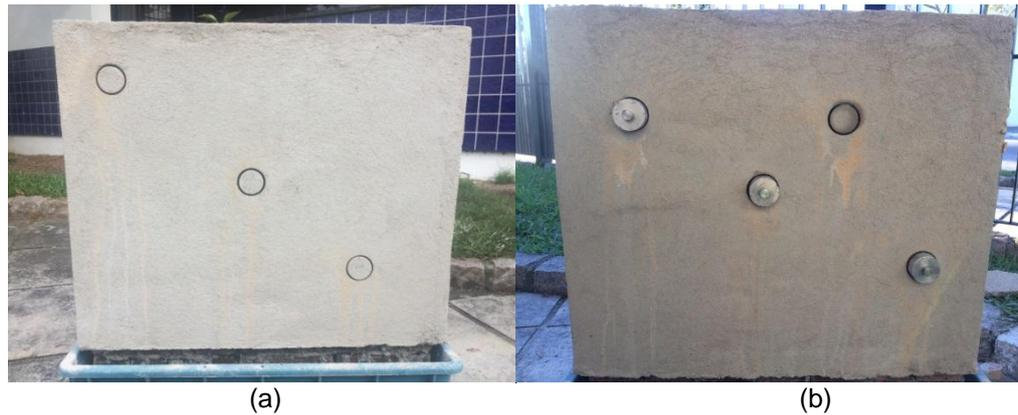
Figura 42 – Pontos para execução do ensaio de aderência à tração; (a) Face com três pontos de ensaio; (b) Face com quatro pontos de ensaio.
