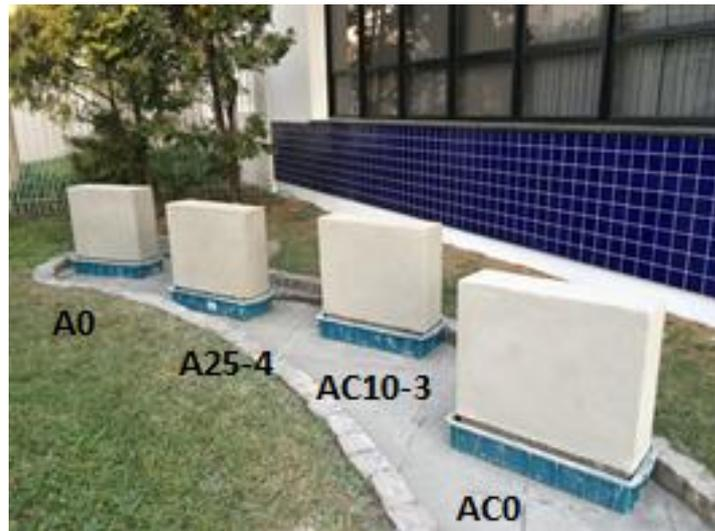
Figura 35 – Protótipos de alvenaria expostos no ambiente externo.
