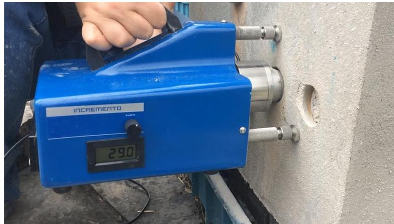
Figura 45 – Execução do ensaio de resistência de aderência à tração.
