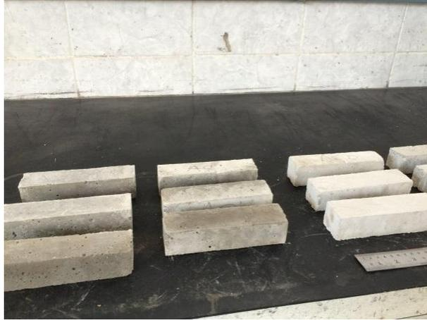
Figura 36 – Corpos de prova prismáticos.
