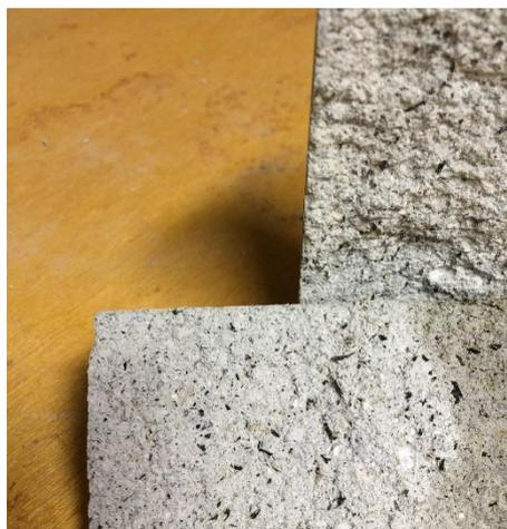
Figura 54 – Argamassa com substituição nas quatro frações de agregado miúdo.
