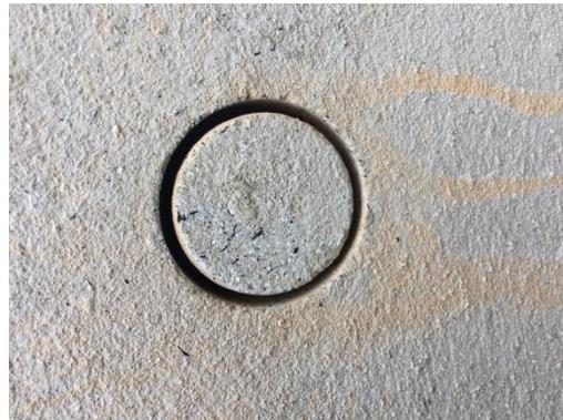
Figura 43 – Corte prévio do corpo de prova se estendendo dentro da superfície do substrato.
