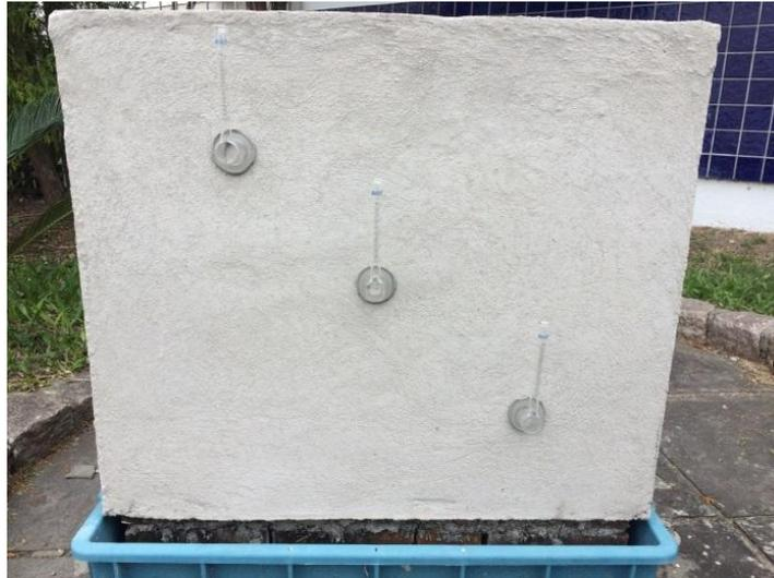
Figura 41 – Execução do ensaio de permeabilidade pelo método cachimbo.
