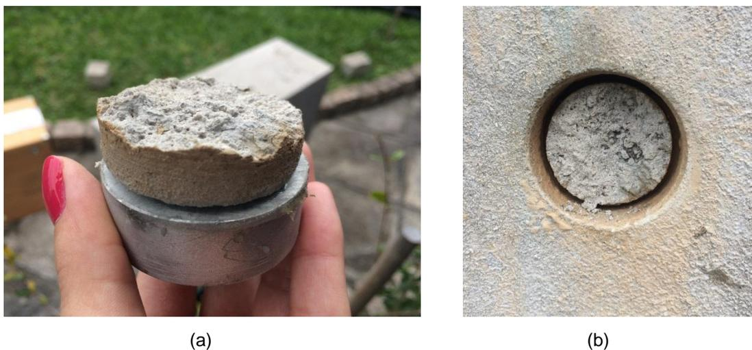
Figura 69 – Ruptura tipo E; (a) Amostra com ruptura tipo E; (b) Local onde ocorreu a ruptura tipo E.
