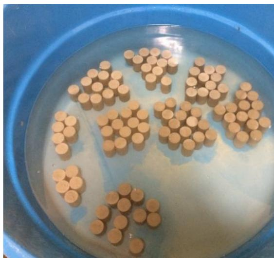
Figura 25 – Cura por imersão em tanque com água.
