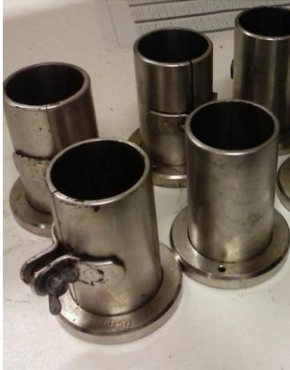
Figura 22 – Corpos de prova cilíndricos.
