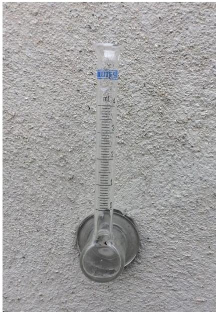
Figura 39 – Cachimbo fixado à parede.
