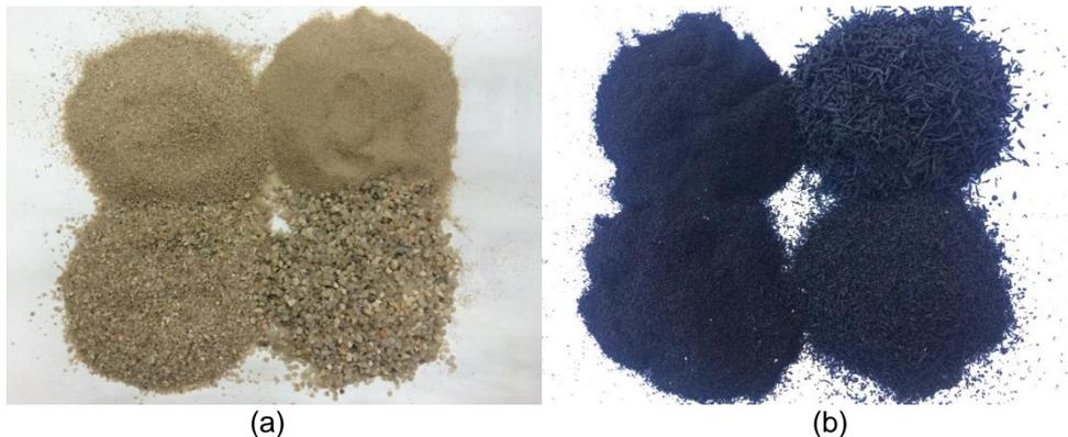
Figura 17 – Agregados peneirados; (a) Frações da areia; (b) Frações do resíduo de borracha.
