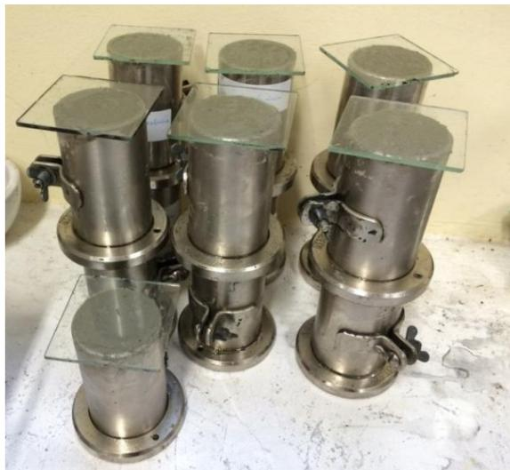
Figura 23 – Corpos de prova nas primeiras 24 horas.
