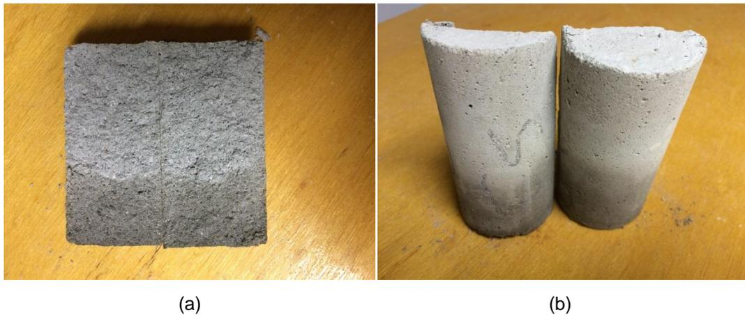
Figura 31 – Rompimento diametral após ensaio de absorção; (a) Visão de topo do corpo de prova rompido; (b) Detalhe da marca da água absorvida no ensaio.
