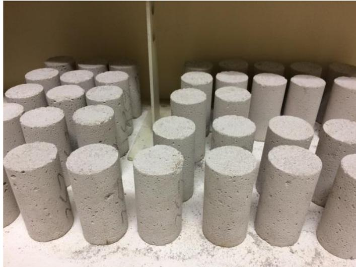
Figura 26 – Cura ao ar e à temperatura ambiente.
