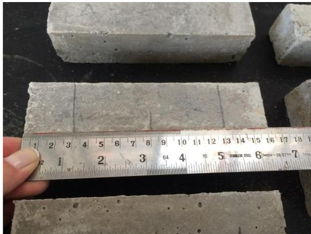
Figura 37 – Marcação dos pontos de apoio dos roletes nos corpos de prova prismáticos.
