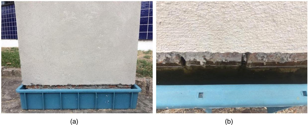
Figura 34 – Protótipo de alvenaria executado dentro de recipiente com lâmina da água; (a) Vista mostrando reboco acima do nível do recipiente com água; (b) Detalhe da água encostando somente nos tijolos.
