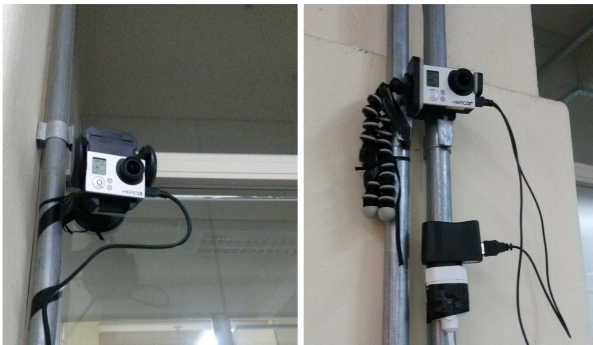
Figura 20 - Câmeras GoPro instaladas para o registro de fotografias sequenciais nos EA 01 e EA 02, respectivamente.
