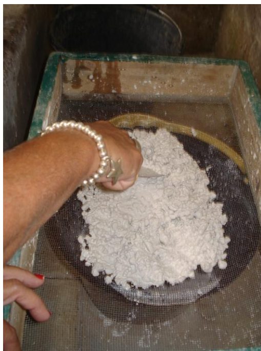
Figura 35 – Peneiramento da pasta de cal hidratada.
