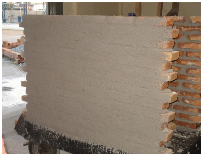
Figura 25 - Lateral da parede para ensaios com chapisco.
