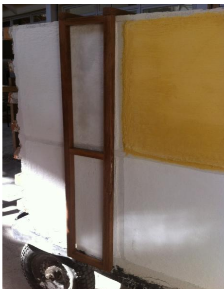
Figura 43 - Posicionamento do gabarito na alvenaria para a realização do teste de abrasão. Fonte: acervo da autora (março de 2011)
