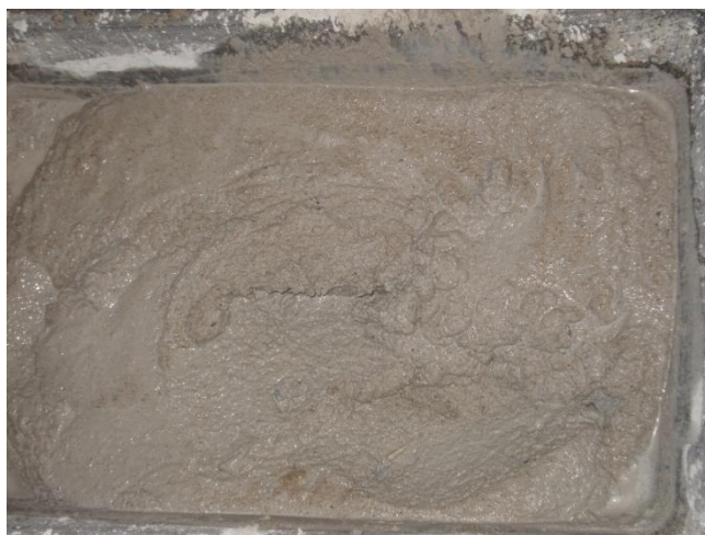
Figura 23 - Argamassa de cal hidráulica e areia média, traço 1:3 (volume). Fonte: acervo da autora (dezembro de 2011).
