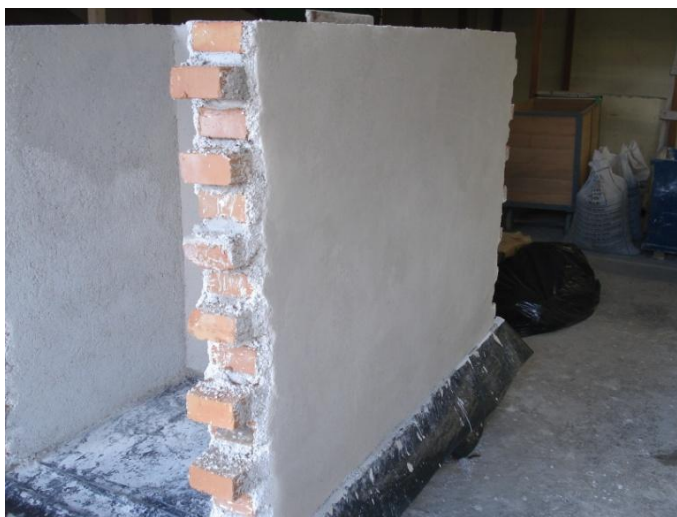
Figura 27 – Alvenaria – H após a execução do reboco.
