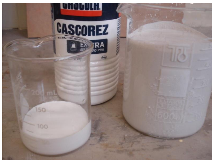
Figura 38- Materiais utilizados para a fabricação da tinta de cal com cola branca. Fonte: Acervo da autora (fevereiro de 2012).
