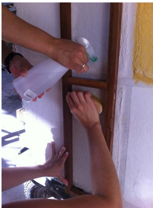
Figura 44 - Aplicação dos testes de abrasão com os materiais indicados. Fonte: acervo da autora (março de 2012).
