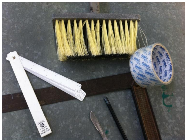
Figura 49 - Materiais utilizados no teste de resistência de aderência.
