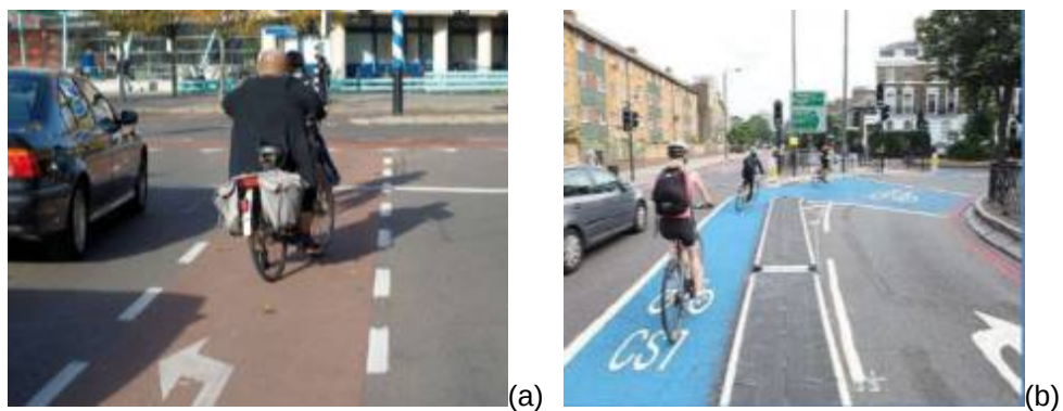
Figura 33. Sinalização nas ciclofaixas. (a) Ciclofaixa em Veenendaal, Holanda; (b) ciclofaixa em Londres, Inglaterra. Fonte: (a) Cycling in the Netherlands, 2007 (b) Transport for London, 2010
