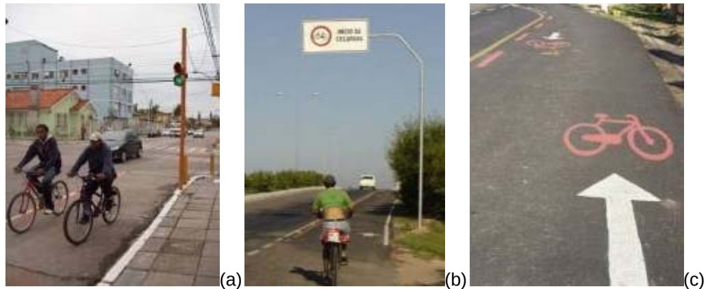
Figura 37. Sinalização. (a) Semáforo para aos ciclistas; (b) sinalização vertical; (c) sinalização horizontal. Fonte: Arquivo pessoal da autora, 2010.
