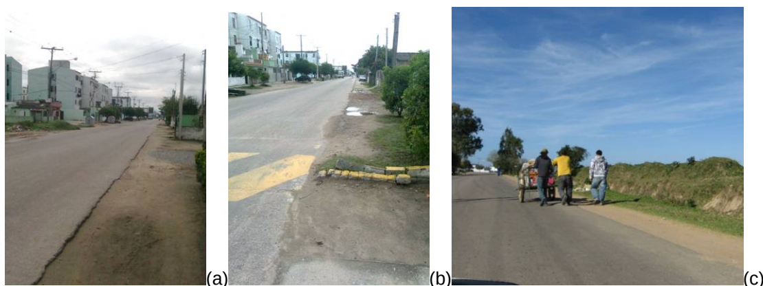
Figura 166. Principais problemas apontados pelos ciclistas na ciclofaixa da Av. Leopoldo Brod. a ) pavimentação em estado ruim e b) e c) sinalização problemática. Fonte: arquivo pessoal da autora, 2012.
