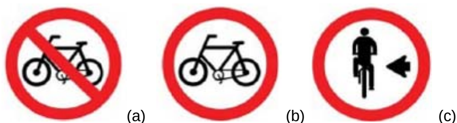
Figura 39. Sinalização vertical. (a) proibido trânsito de bicicletas; (b) circulação exclusiva de bicicletas; (c) ciclista, transite à esquerda. Fonte: CONTRAN, 2007.
