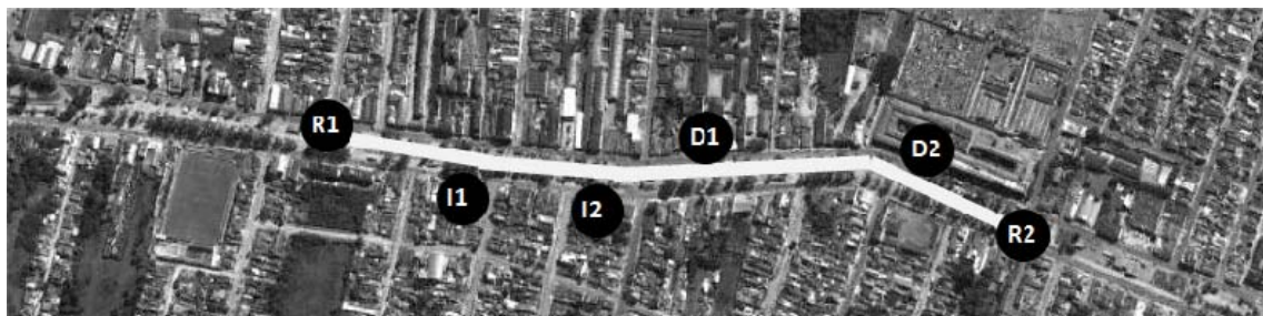
Figura 95. Trecho 2 da Ciclovia na Avenida Duque de Caxias, compreendido entre a Rua Frontino Vieira (R1) e Rua Bernardo José de Souza (R2). Foram encontrados problemas de drenagem nos pontos D1 e D2 e problemas de iluminação nos pontos I1 e I2. Fonte: Estudo da autora sobre imagem de satélite, 2011.
