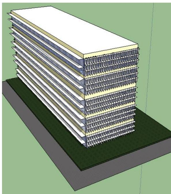
Figura 27 Modelo base com brises em 3D
