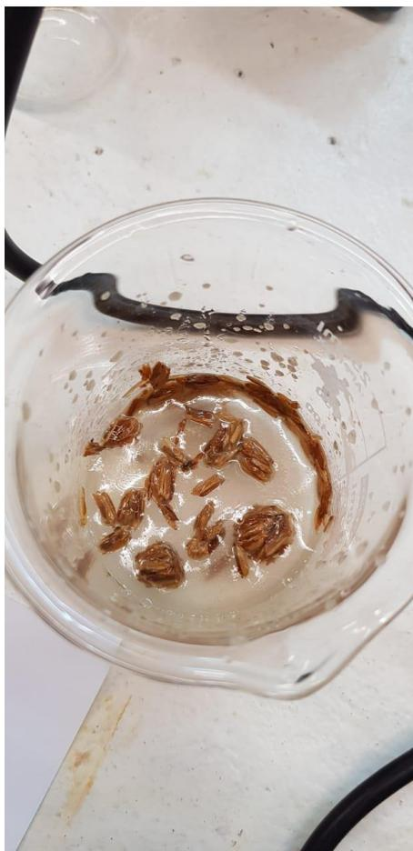
Figura 8: Adsorção de óleo em meio aquoso.
