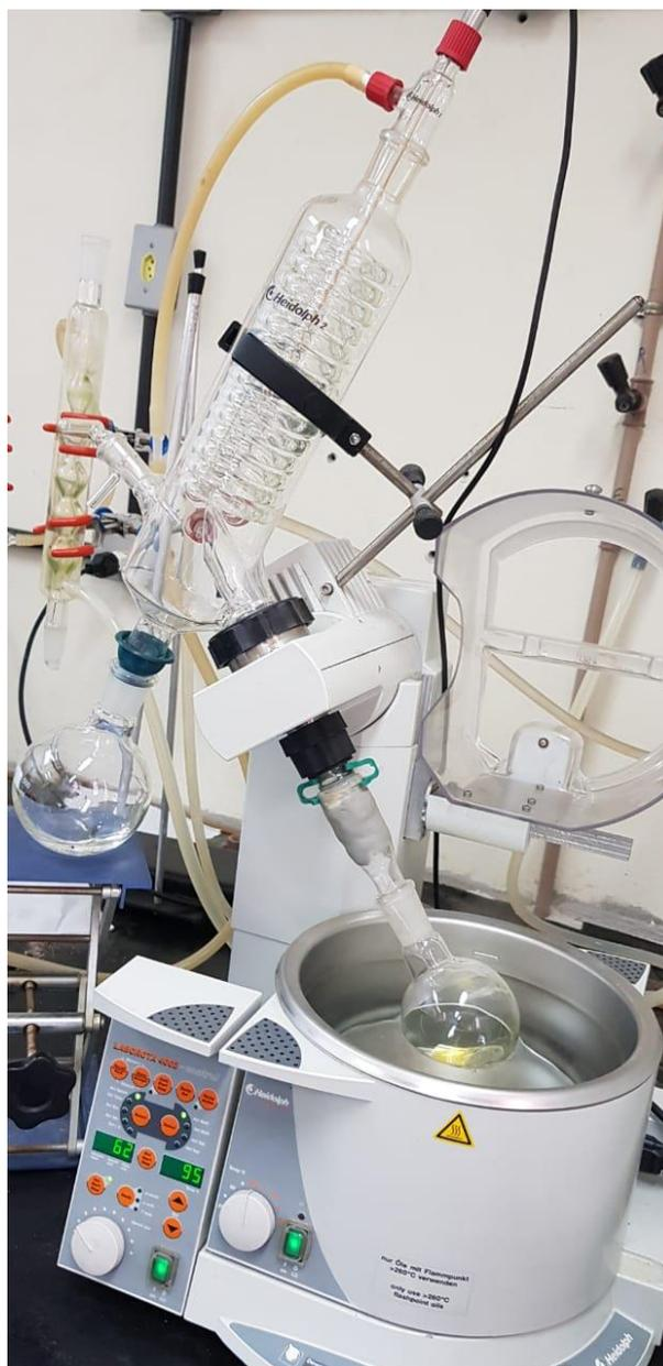
Figura 7: Separação líquido-líquido pelo rotavaporador.
