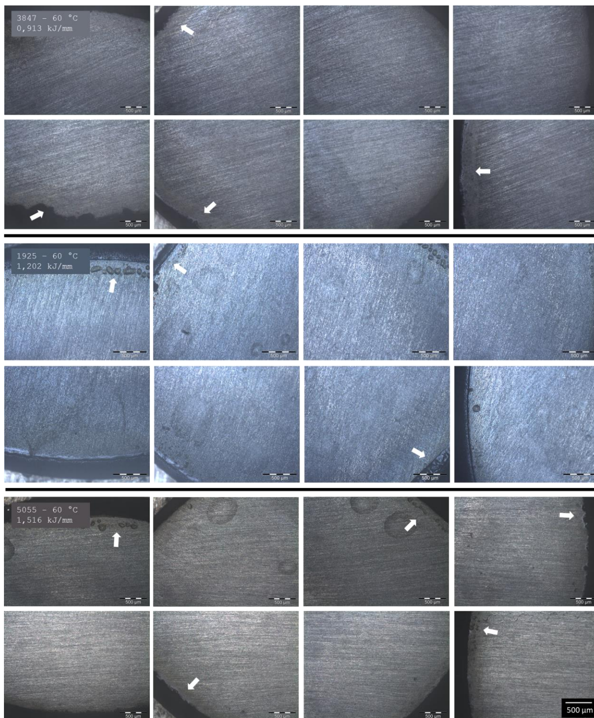
Figura 27 - Imagens de microscópio óptico da superfície das amostras dos revestimentos submetidas à corrosão a 60 °C, as setas indicam regiões de corrosão por frestas. As amostras possuem uma superfície circular, mas para melhor visualização da superfície foram realizadas oito imagens que juntas compõem toda a área superficial da amostra.
