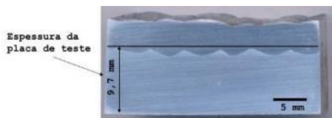
Figura 15 - Método para determinação da superfície da chapa utilizando a borda inferior como referência com intuito de delimitar a área fundida do revestimento
