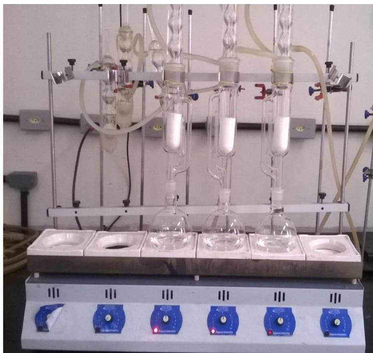
Figura 9 – Equipamento de Extração Soxhlet utilizado para caracterização da celulose por meio das normas TAPPI. (Caracterização realizada no Laboratório de Química da Madeira da Universidade Federal de Pelotas).
