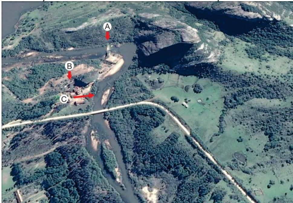
Figura 21: a – Barragem construída pelos Belgas; b – Usina de Beneficiamento; c – provável caminho do rejeito saindo da Usina de Beneficiamento em direção ao Arroio João Dias.
