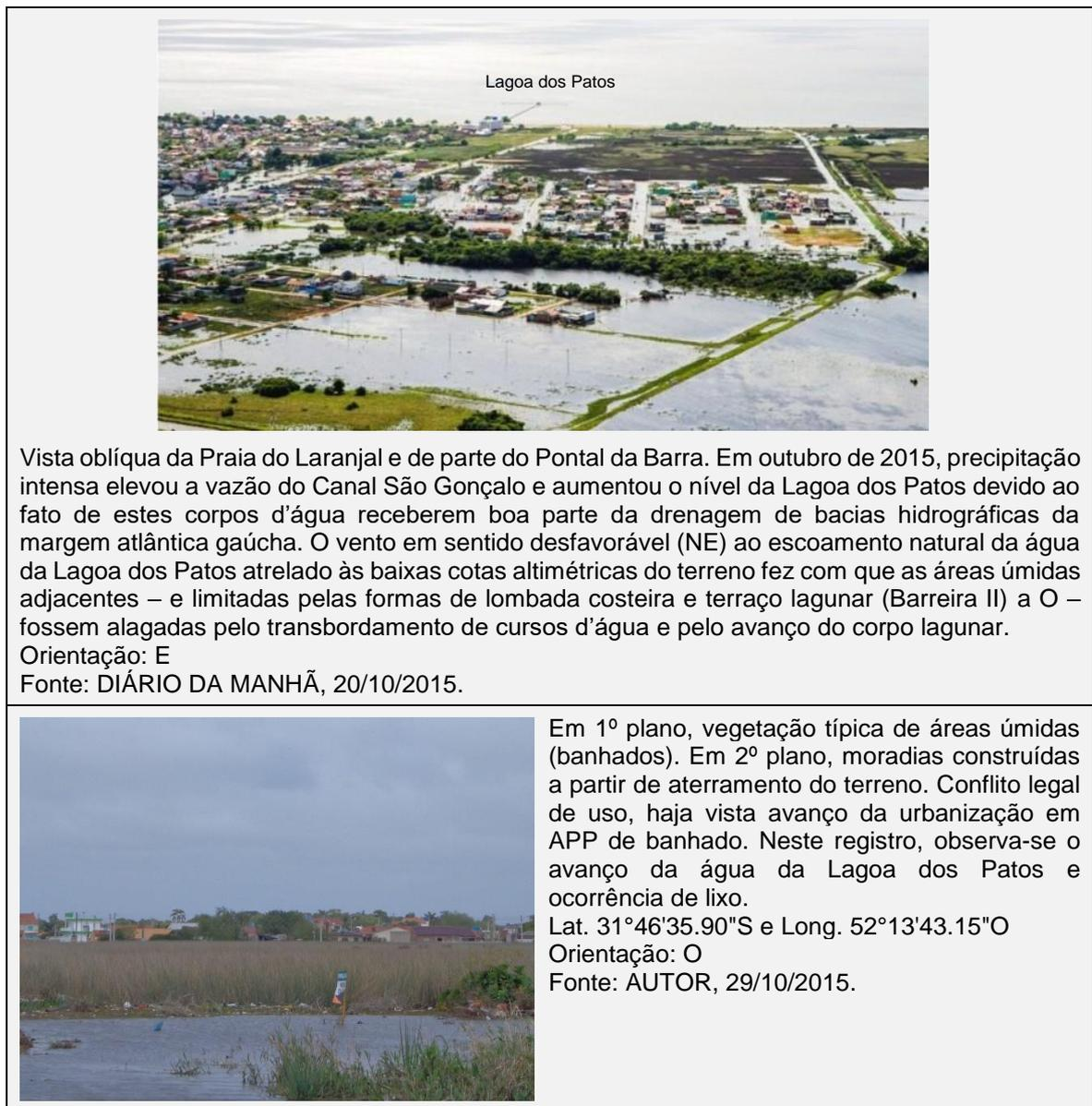
Figura 76 - Alteração de morfodinâmicas do relevo em área de influência da Lagoa dos Patos e do Canal São Gonçalo resultantes de intervenções antrópicas.
