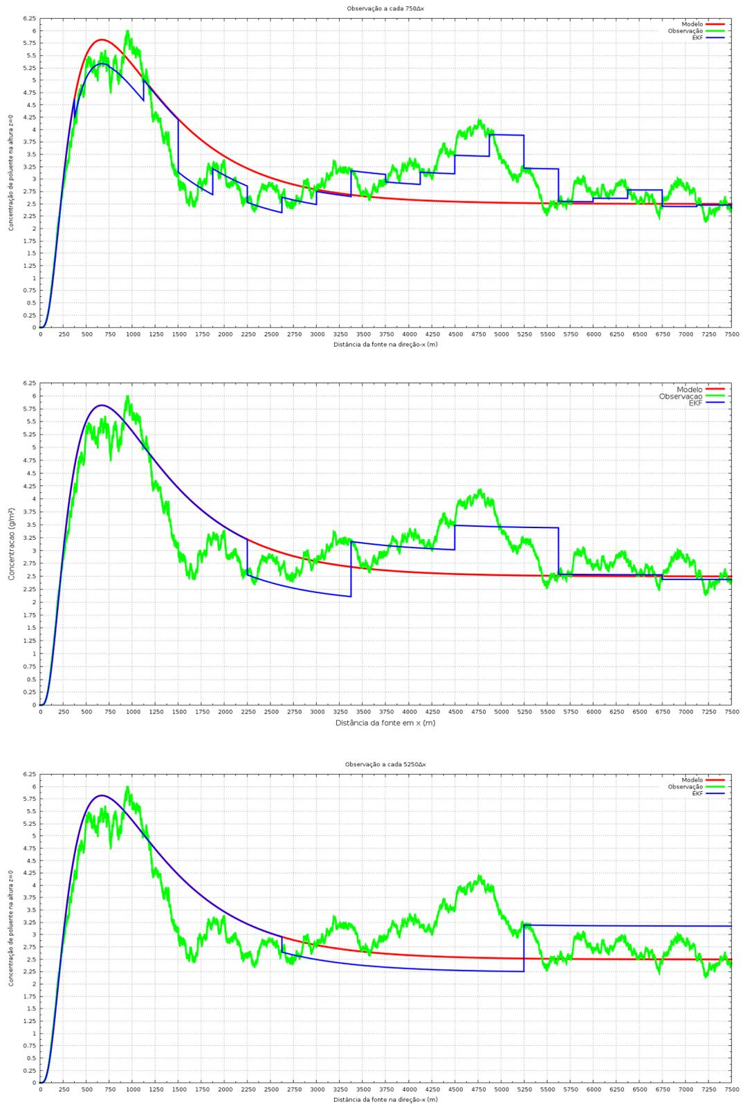
Figura 4: Efeito da freqüência de observação no EKF: (a) EXP2, (b) EXP4
