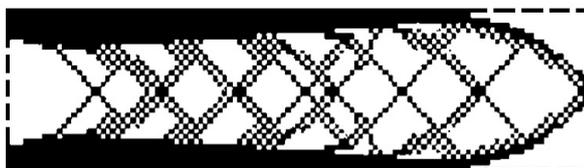
Figura 10: Topologia com instabilidade de tabuleiro. Fonte: Adaptado de Bendsøe e Sigmund, 2003, p. 39.
