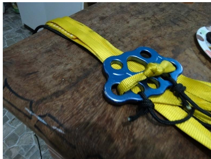
Fita e placa de ancoragem que liga os ganchos às cordas.
