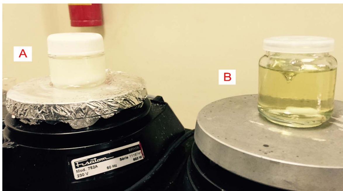
Figura 11 - Processo de preparação de sol de \text{ZrO}_2/\text{PEG} Fonte: O autor
