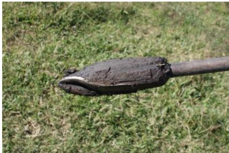
**Figura 15** – Característica de coloração do solo muito mal drenado do Taim descrito como **Gleissolo Melânico**, após a tradagem do perfil com trado holandês e sua classificação, apresentando traços ou características de hidromorfismo com acumulação de matéria orgânica e sua coloração escura que distorce a observação de manchas de ferrugem. Imagem do banco de dados do autor, Taim/RS em 26 de maio de 2014.
