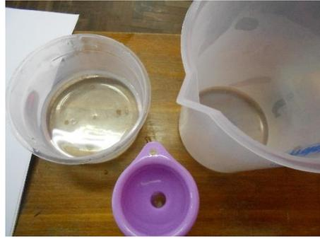
Figura 8 - Medindo o volume precipitado
