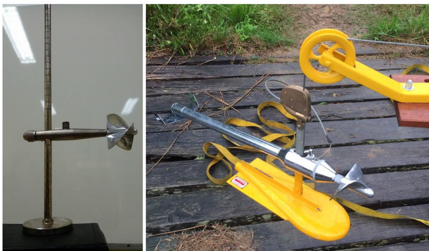
Figura 28 - Exemplos de molinetes hidrométricos utilizados para determinação de vazões em cursos d'água.
