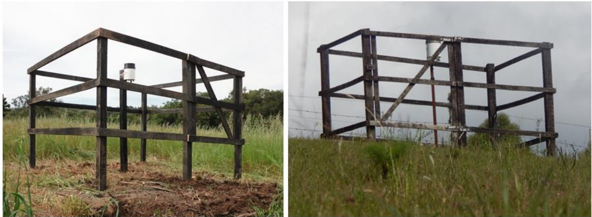
Figura 24 - Exemplos de estação pluviográfica, modelo RG3-M da marca Onset, localizadas no interior da BHAP.
