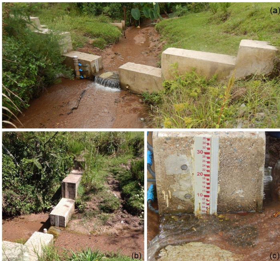
Figura 22 – Canal da seção de controle da sanga do Ellert (a), disposição das réguas ao longo do canal (b) e detalhe da régua linimétrica localizada junto à base do canal (c).
