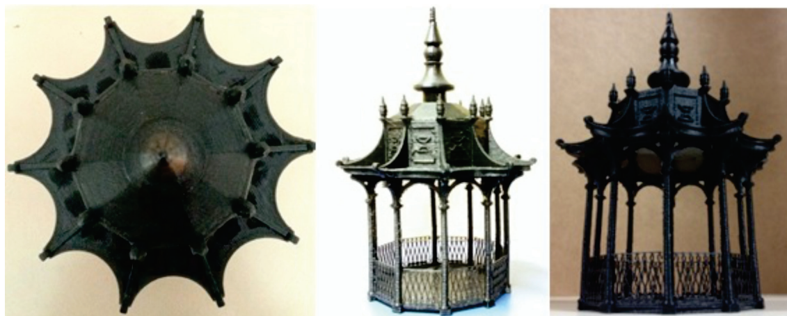
Fig. 6 - Torreão do reservatório produzido por impressão 3D Fonte: autoras.
