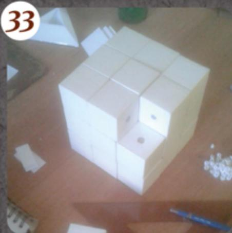
Fotografia dos cubos em Papel Pluma, com sistema magnético instalado
