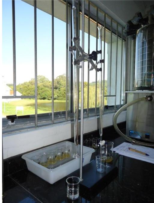
Figura 7 – Instrumentos utilizados para a coleta de gotas na análise da determinação da tensão superficial realizada através do método do peso da gota. Pelotas, RS, 2015.
