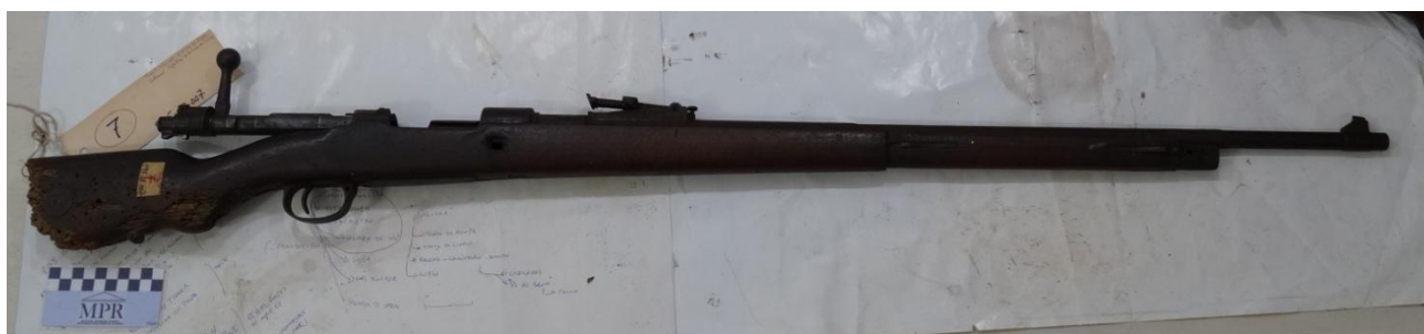
Figura 85 – Fusil Mauser com o cabo de madeira destruído por brocas e oxidação nos componentes metálicos. Algumas partes com vestígios de tinta prateada e etiqueta de papel colada na culatra. Foto: Taciane Souza, 2015.
