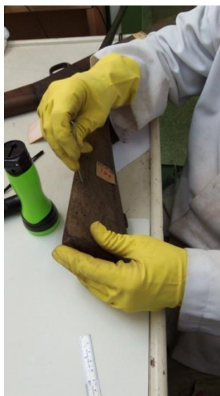
Figura 19 – Análise de uma das armas, verificando a presença de xilófagos e magnitude dos danos nos componentes em madeira. Foto: Taciane Souza, 2015.
