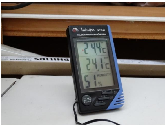
Figura 62 – Medição da UR e da temperatura através de um termohigrômetro. Foto: Taciane Souza, 2015.
