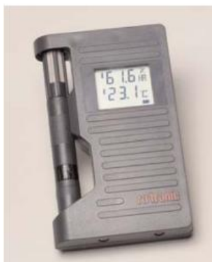
Figura 59 – Datalogger aparelho capaz de registrar temperatura e UR em intervalos determinados pelo usuário.
