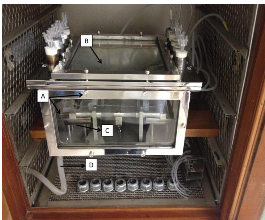
Figura 9 – Câmara fechada acoplada a estufa de aquecimento. A e B) Janelas em vidro temperado (aberturas); C) Inclinação das unidades individuais; D) Mangueira de silicone para eliminação de resíduos.
