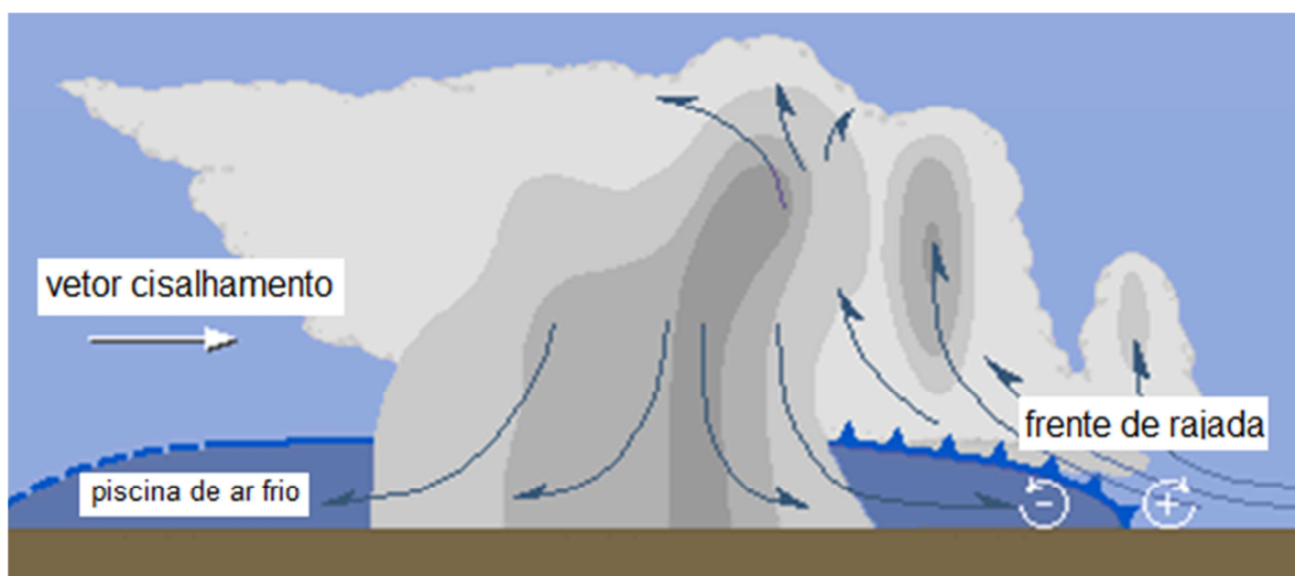
Figura 4 – Esquema ilustrativo da interação entre a piscina de ar frio, frente de rajada e cisalhamento vertical do vento em uma linha de instabilidade.
