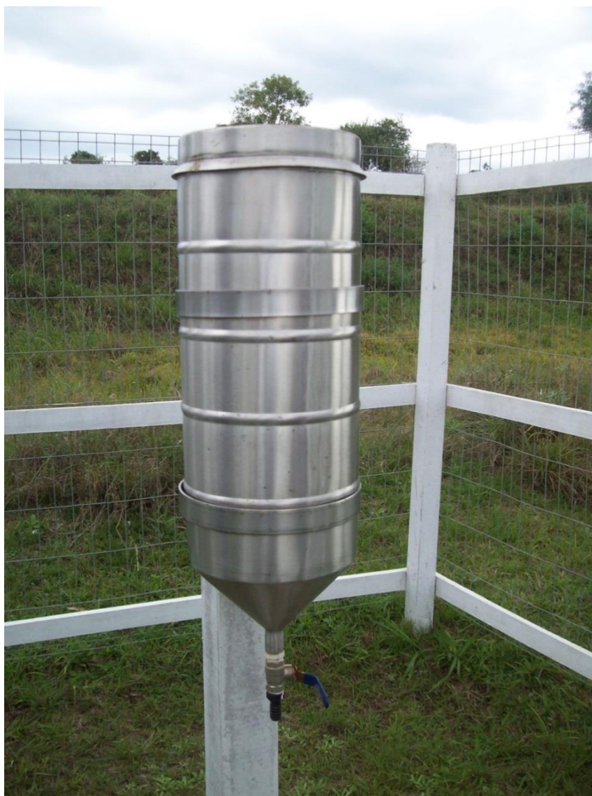
Figura 45: Pluviômetro instalado em uma propriedade na Ponte cordeiro de Farias- Próximo a foz do Arroio Quilombo Fonte: RUTZ (2015)
