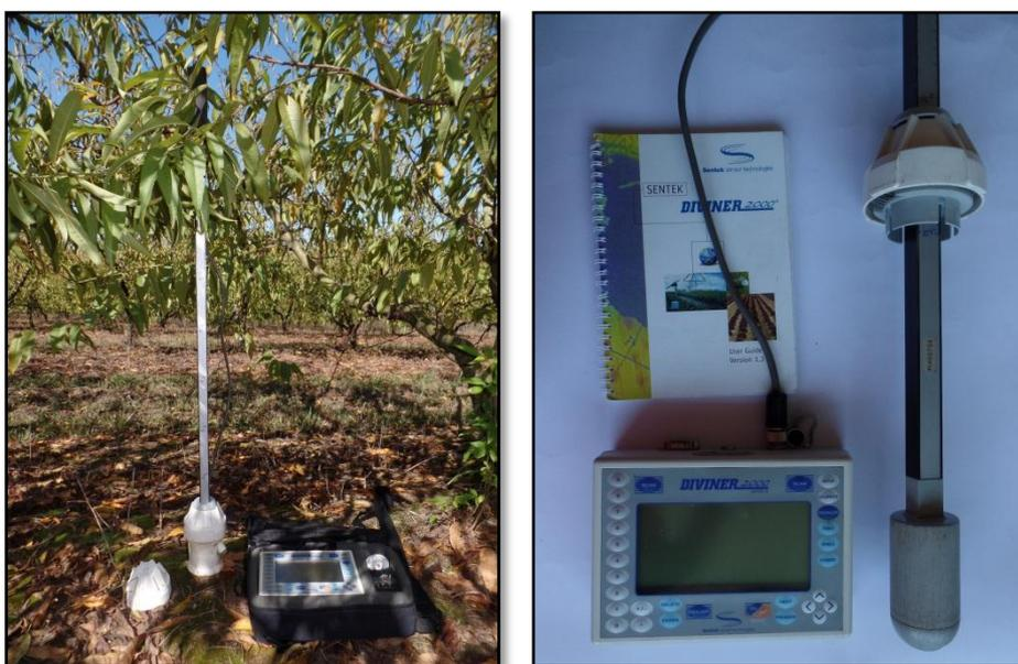
**Figura 5:** Sonda de capacitância modelo Diviner 2000® utilizada para monitorar o conteúdo de água no solo. Fonte: O Autor.
