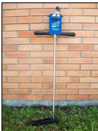
**Figura 4:** Câmara de pressão de "Sholander" utilizada para medir o potencial de água no ramo. Fonte: O Autor.
