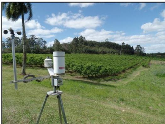
**Figura 3:** Estação Meteorológica Automática Squitter modelo ISIS S1220, utilizada para coleta de dados de chuva, evapotranspiração potencial, temperatura do ar, umidade relativa média do ar, radiação solar e velocidade do vento. Fonte: O Autor.
