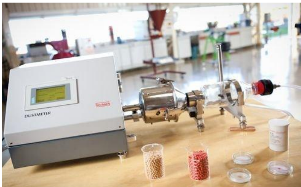
Figura 1. Equipamento para teste de medição do desprendimento de poeira “Dust Off” J.C. Nunes, 2011.
