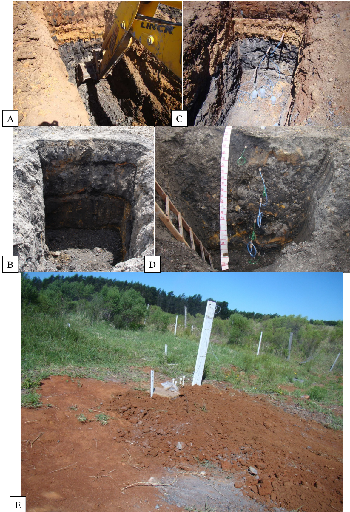
Figura 7 - A = Abertura das trincheiras com retroescavadeira, B = Coleta das amostras deformadas ao longo das paredes da trincheira, C = Lisímetros de sucção instalados na parede do perfil do solo construído, D= Sensores de umidade do solo instalados na parede do perfil do solo construído, E = Cobertura da trincheira.
