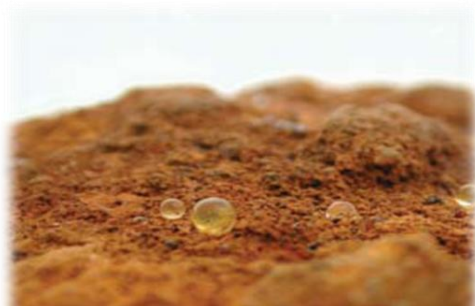
Figura 27 – Presença de gotículas devido a alta umidade relativa do ar no artefato. Fonte: Ankersmit, Griesser-Stermscheg, Selwyn e Sutherland (2008).
