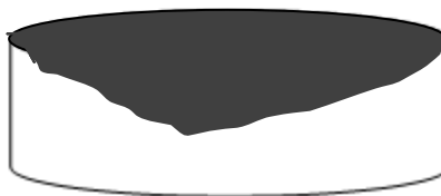
Figura 33 – Corrosão por erosão. Fonte: autora.
