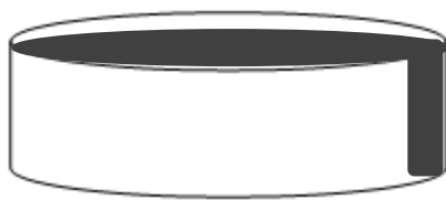
Figura 34 – Corrosão laminar. Fonte: autora.
