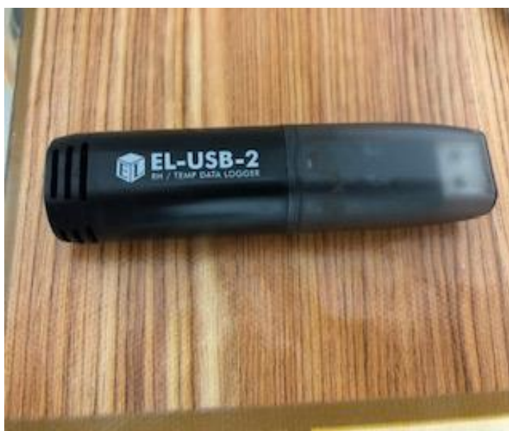
Figura 6- Sensor (Data Logger) empregado para medição de temperatura e umidade relativa do ar
