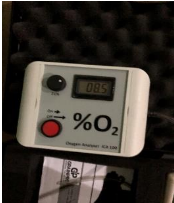
Figura 7- Aparelho para medição da concentração de oxigênio ( \text{O}_2 ).
