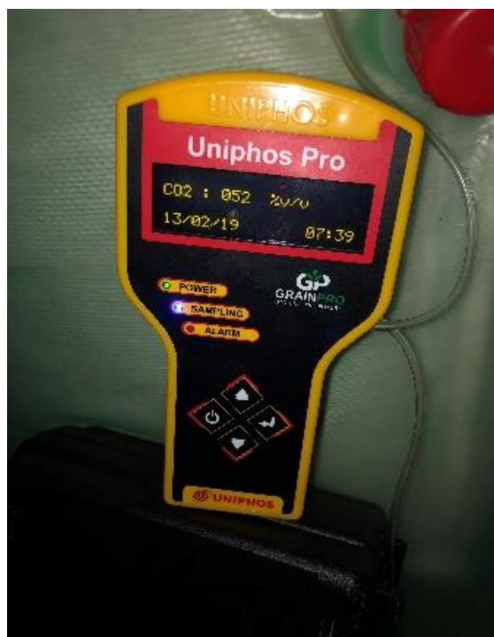
Figura 8- Aparelho para medição da concentração de gás carbônico ( \text{CO}_2 )
