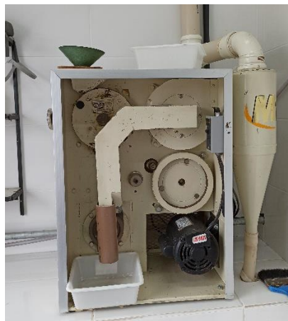
Figura 4. Fotografia da Máquina de descasque da marca Sussuki utilizada para o descasque das amostras de trabalho. Fonte Rubim,2020.
