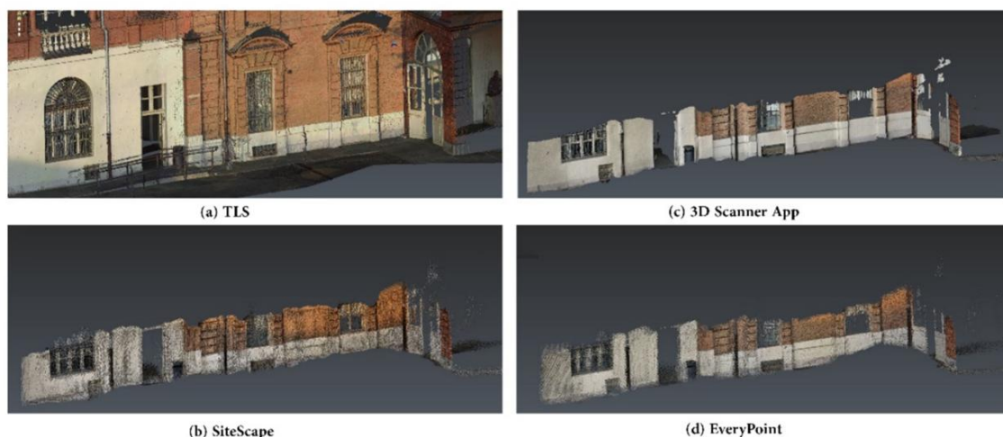
Figura 5: Comparação da nuvem de pontos gerada pelo TLS, 3D Scanner App, SiteScape e EveryPoint.
