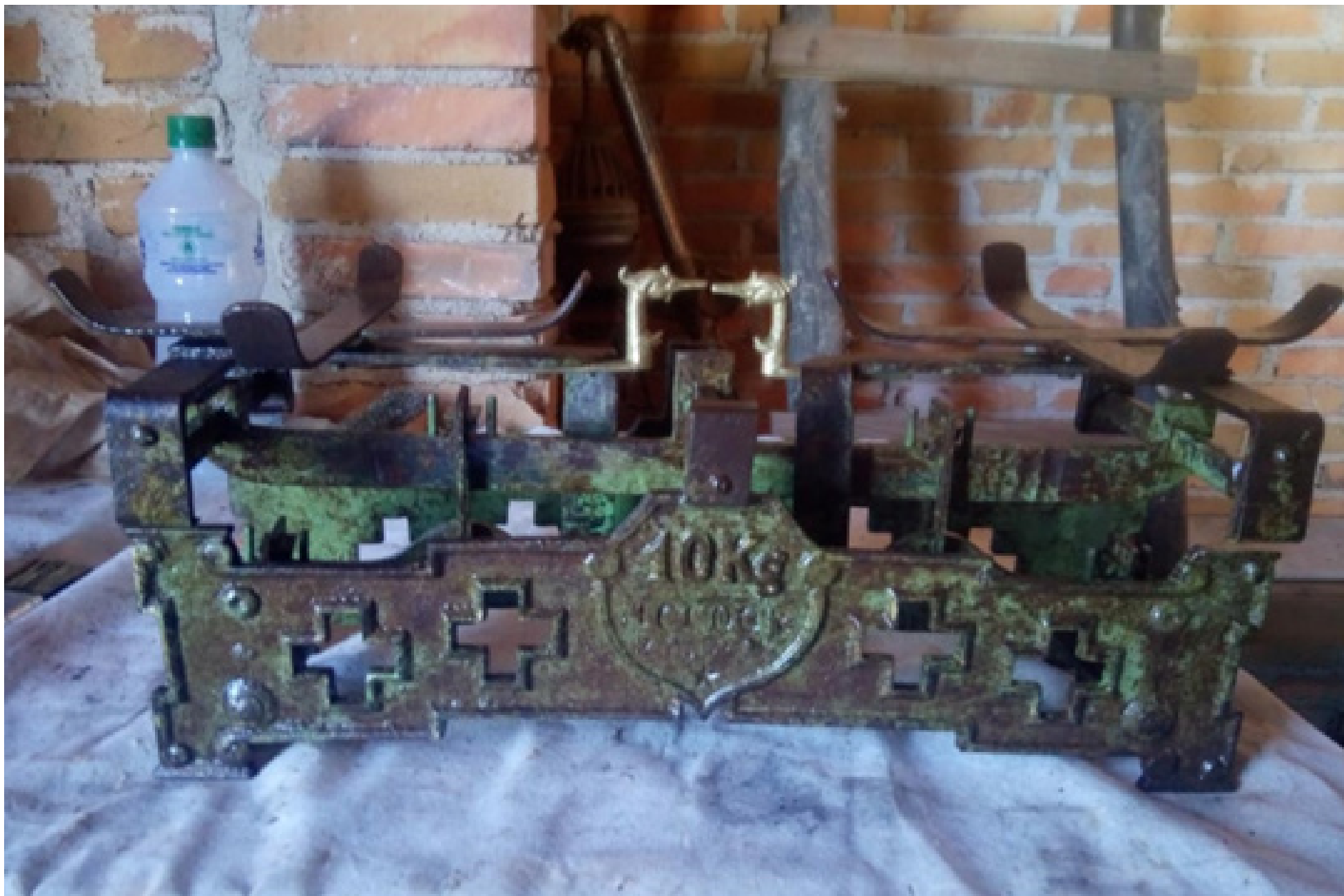
Balança restaurada e com óleo para proteção
