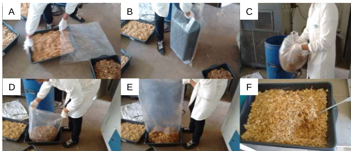
Figura 13 - A - Colocação das bandejas com material úmido nos sacos plásticos; B – Viragem do material dentro do saco plástico; C – Revolvimentos do saco plástico; D e E – Despejo do material na sua bandeja original; F – Material pré-seco.
