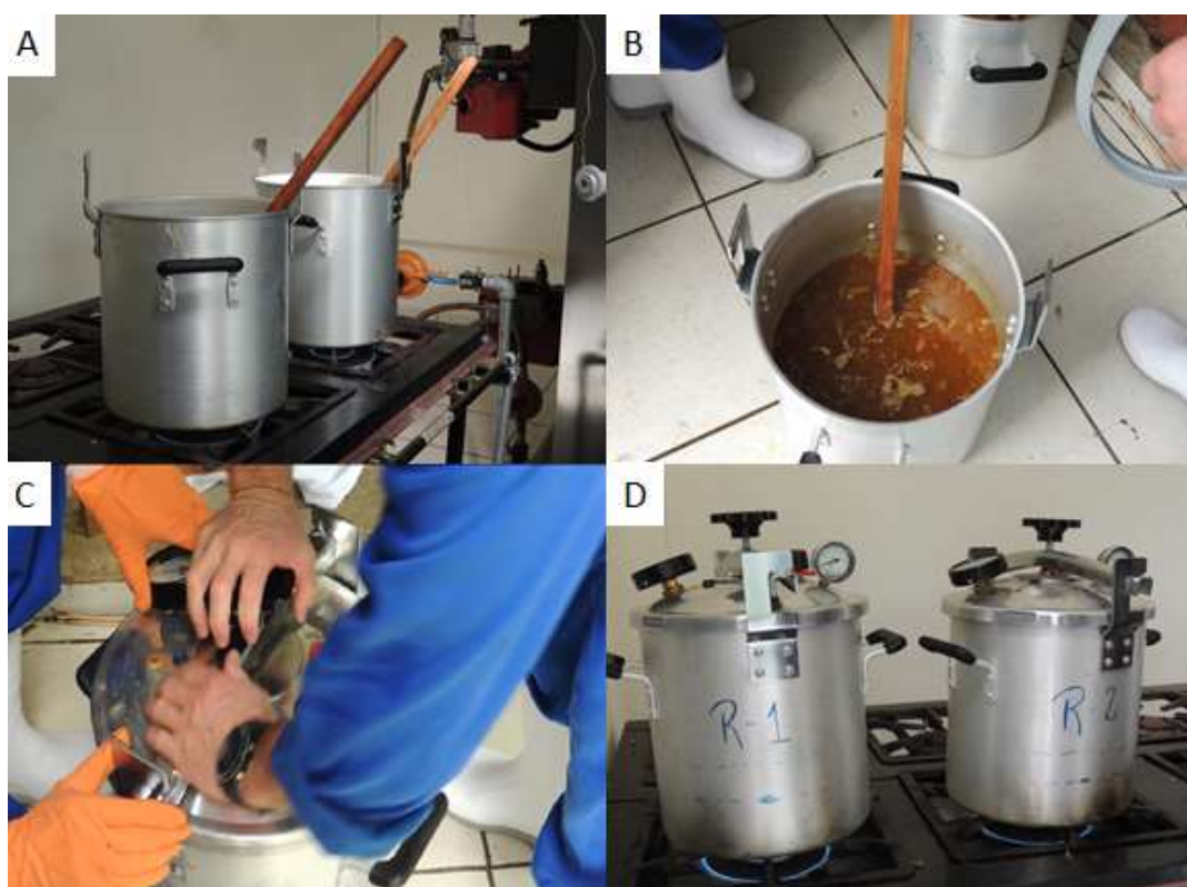
Figura 9 - A – Cozimento da massa por 30 minutos e pás para fazer os revolvimentos; B – Retirada da panela após 30 minutos; C – Fechamento da panela; D – Panelas tampadas para mais 30 minutos de cozimento com pressão.
