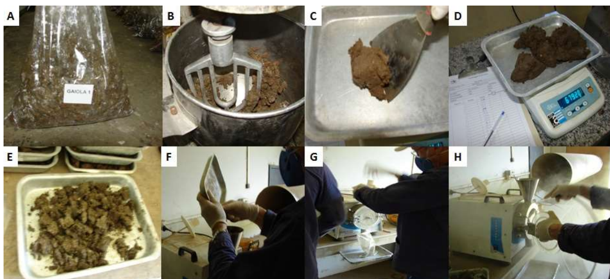
Figura 23 - A – Descongelamento das amostras das fezes; B – Mistura das fezes de cada repetição; C – Retirada de uma amostra de 500 g; D – Pesagem da amostra; E – Amostra depois de pré-seca; F – Moagem da amostra; G – Depósito da amostra moída em sacos plásticos identificados; H – Limpeza do moinho realizada no intervalo de cada amostra a ser moída.
