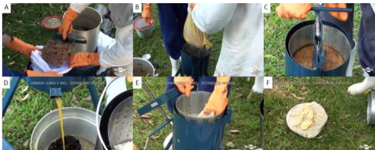
Figura 10 - A – Retirada da massa prensada; B – Colocação da massa na prensa; C – Prensagem; D – Coleta de óleo da prensagem; E – Retirada da massa após a prensagem; F – Massa prensada.
