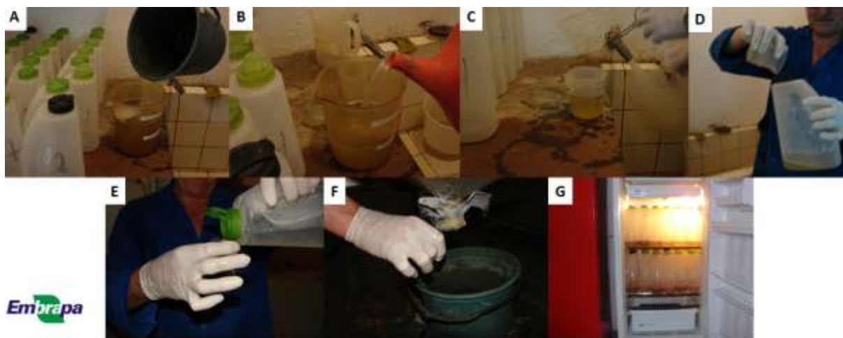
Figura 22 - A – A urina coletada de cada repetição era despejada em recipiente com marcador de volume; B – A quantidade que faltava para completar 3 L era preenchida com água destilada; C – Retirada da amostra de urina; D – Deposição da amostra em recipiente para o seu armazenamento durante os cinco dias de coleta; E – 20 mL de HCL (diluído na proporção 1:1); F – Adição do ácido diluído aos recipientes de coleta de urina; G – Armazenamento dos recipientes com as amostras de urina em ambiente refrigerado.
