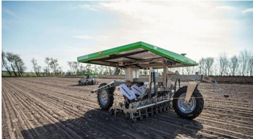
Figura 24 - Veículo autônomo FarmDroid para sementeira e capina.
