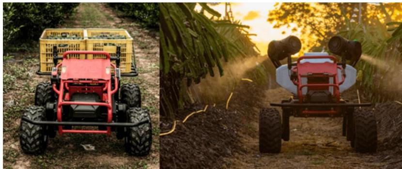
Figura 29 – XAG. Veículo autônomo para transporte e pulverização.
