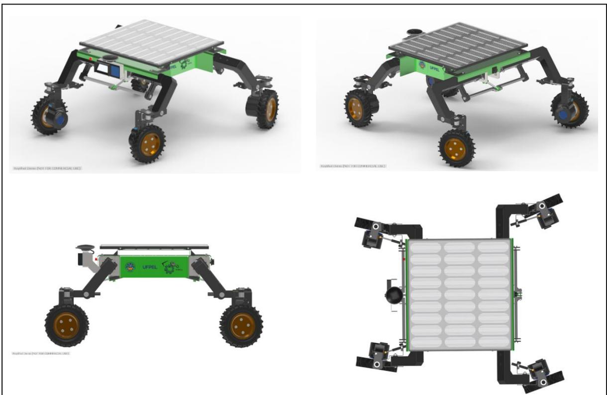
Figura 62 – Desenho conceitual do veículo autônomo elétrico para fins agrícolas\*.
