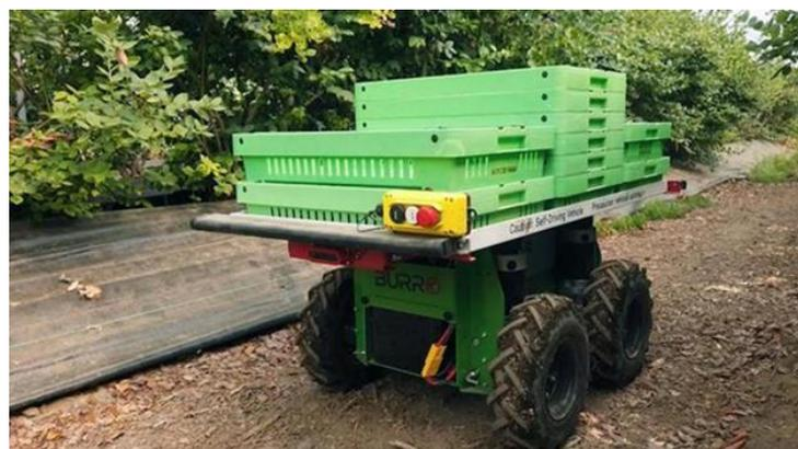
Figura 28 – Veículo Burro platform para transporte e monitoramento de produtividade das colheitas.
