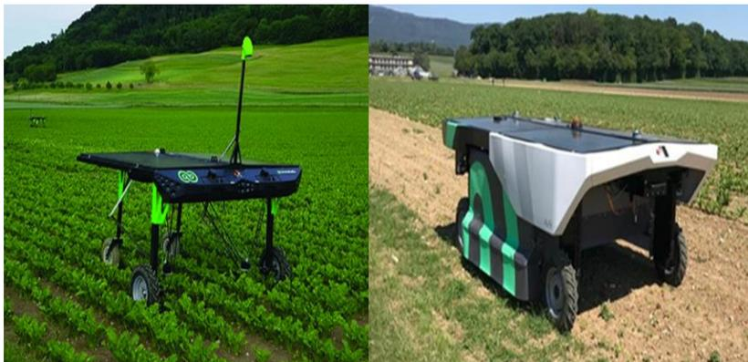
Figura 21 - Smart Weeding e AVO Weeding: Pulverizadores para controle de plantas invasoras. Fonte: ECOROBOTIX, 2020.
