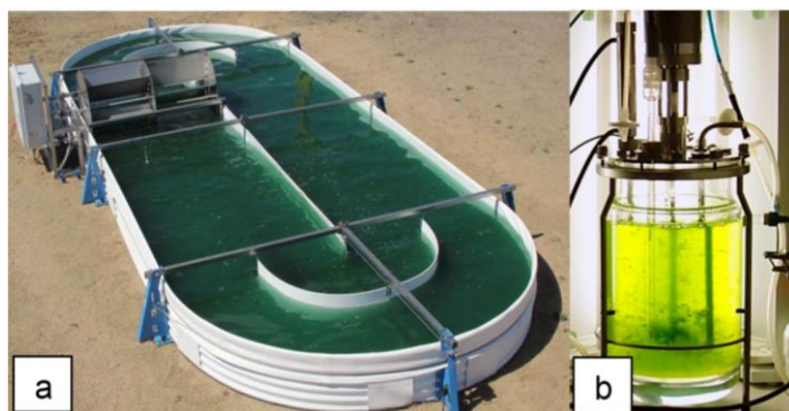
Figura 1: Sistemas de cultivo de microalga. a) Cultivo de microalga em tanques abertos tipo raceways. b) Cultivos fechados em fotobioreatores do tipo air lift . Adaptado de: https://microbioengineering.com/rw22-101 ; http://www.plant-biotech.net/bryotechnology_gallery/#3 (b)
