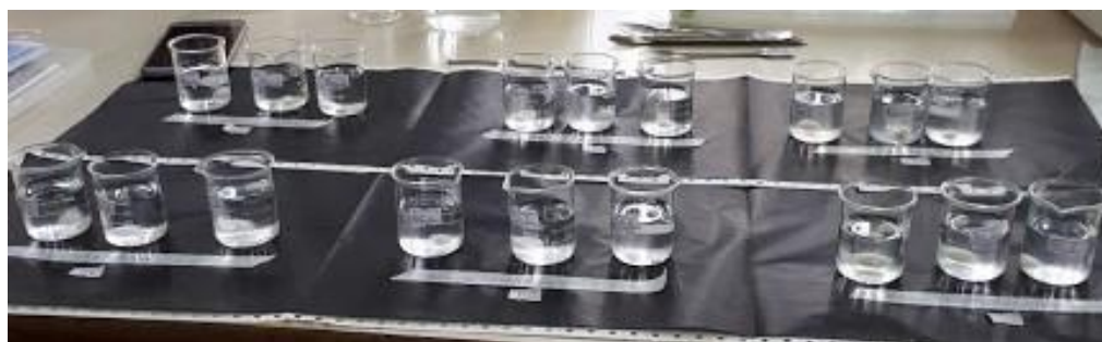
Figura 2. Fotografia do modelo experimental realizado para analisar o teor de intumescimento das amostras de xantana. Fonte: A autora.
