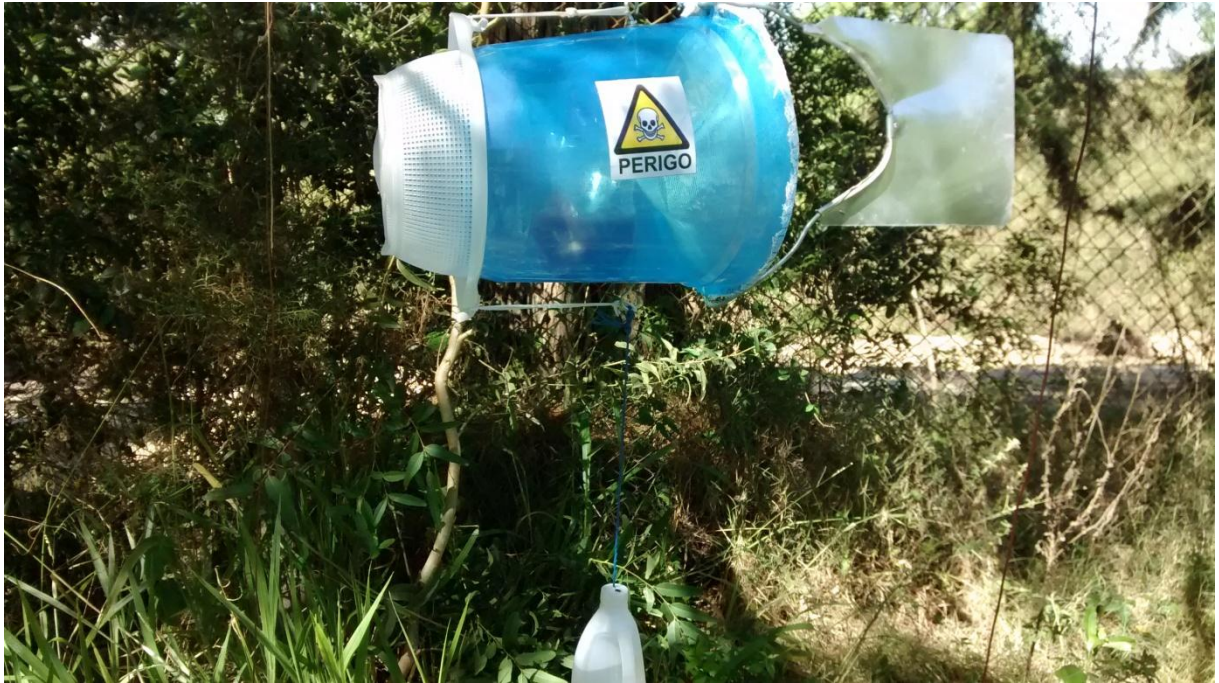
Figura 1: Armadilha orientada pelo vento (W.O.T) segundo modelo de Broce et al. (1970) utilizada no trabalho
