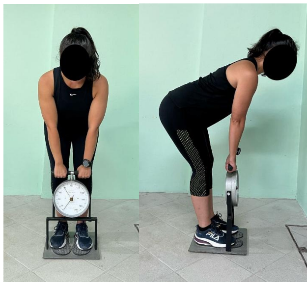
Figura 19 – Medição da força isométrica toracolombar
