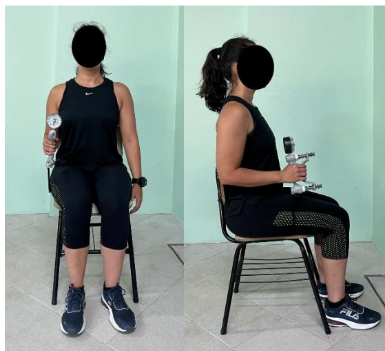
Figura 18 – Medição da força de preensão manual
