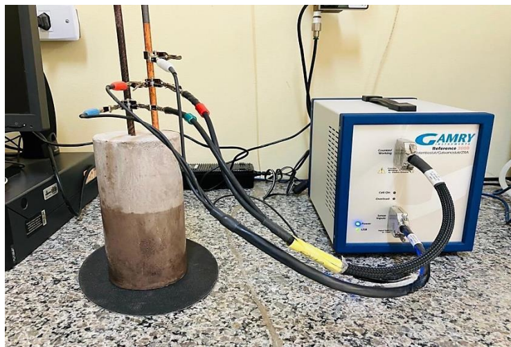
Figura 18 – Análise Espectroscopia de Impedância Eletroquímica com os adaptadores nos eletrodos.
