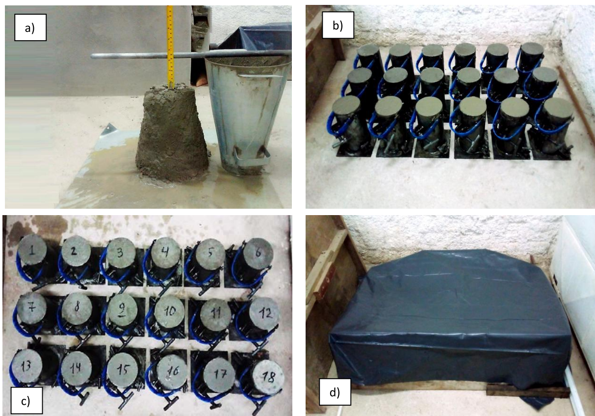
Figura 12 – a) Aferição do Slump test ; b e c) corpos moldados; d) corpos de prova cobertos com lona por 24 horas.
