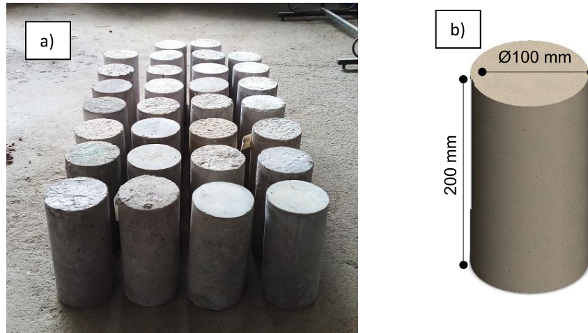
Figura 13 - a) corpos de prova desmoldados; b) desenho esquemático.
